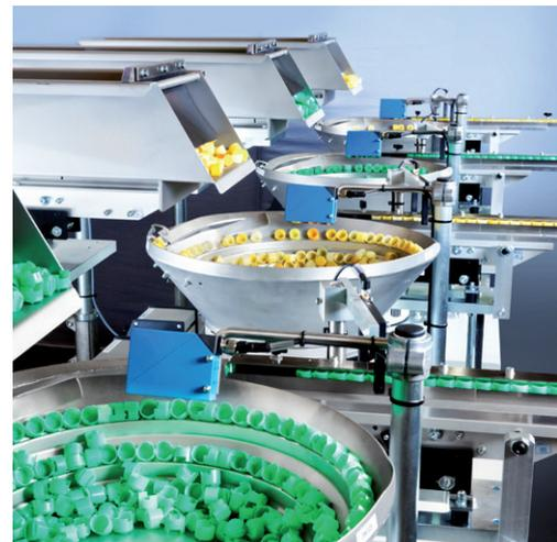
Zuführsysteme auf Basis von Schwingförderern (Rundförderer)
