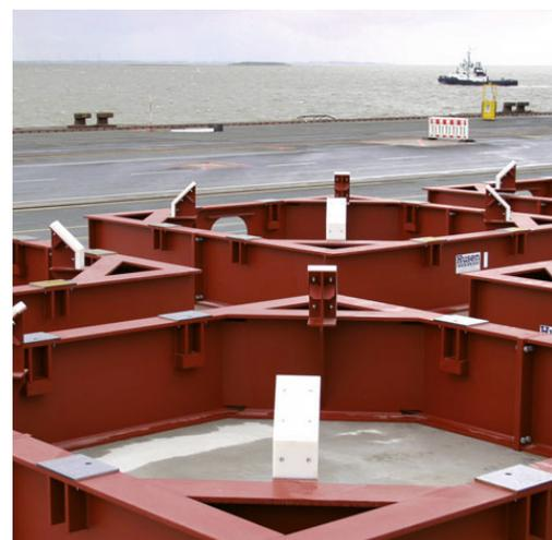
Aufnahmeelemente für Offshore-Windkraft- anlagen am Ausrüstungskai in Bremerhaven
