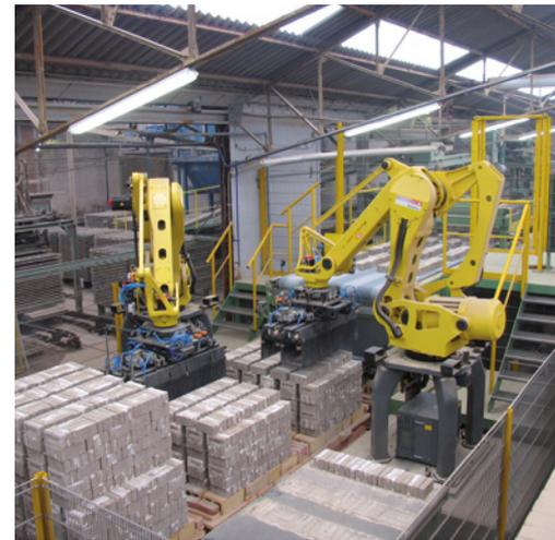
Handling von Ziegeln mit Roboter
